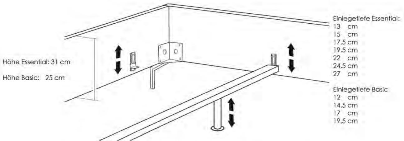
Zum sicheren Fixieren der Lattenroste werden serienmäßig vier Distanzhülsen und Schrauben mitgeliefert.
